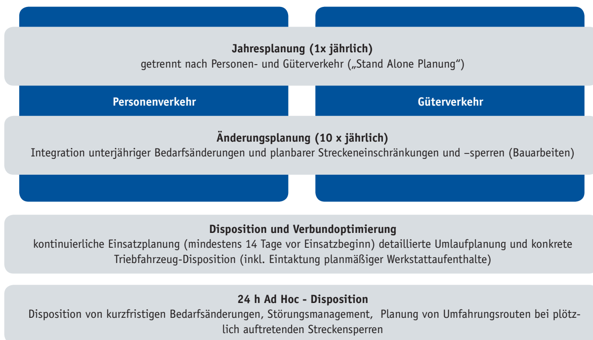
Abbildung 3: Ablaufschema Einsatzplanung und Triebfahrzeugdisposition
